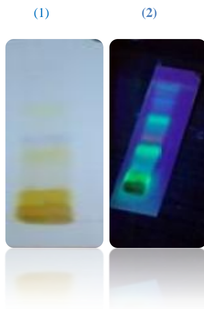
Figure V.2: le chromatogramme de l'extrait acétate d'éthyle de Genista (1) après révélation par «acide sulfurique 25 % et acide acétique 25% » et de l'eau 50 %, (2) sous la lumière UV 365 nm.
